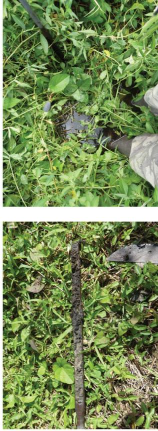
Figure 2. Carottage du sol à l'aide d'une tarière et mesure de la nappe sur le matelas végétal flottant
